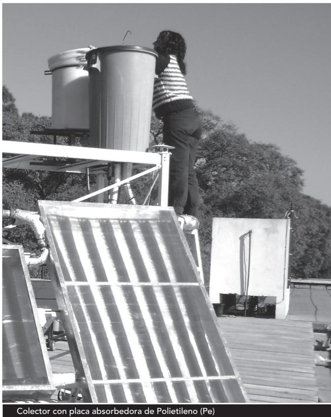
Colector con placa absorbadora de Polietileno (Pe)
