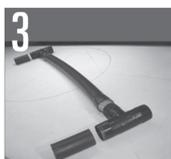
Armado de la pieza base. A un caño de 82 cm, unirle una pieza "T" en cada extremo. Armar 11 piezas iguales.
