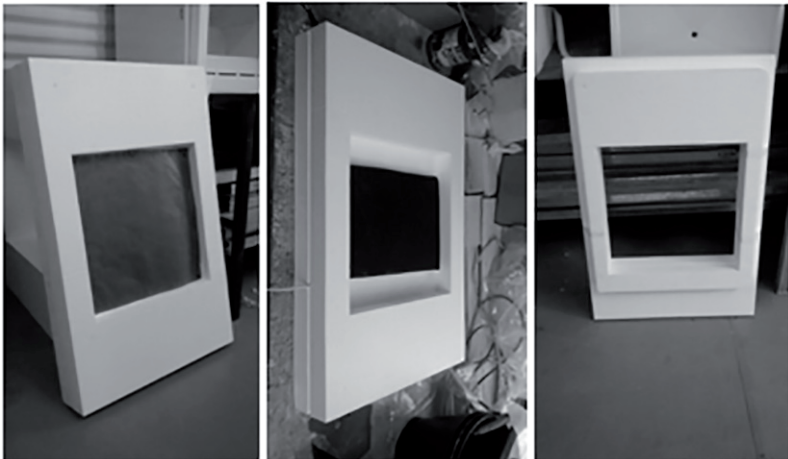
Figura 67. Unidad calefactora, cobertura de chapa de cobre y bastidor de sostén de la probeta.
