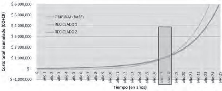
Figura 55. Curvas de costo en función del tiempo a 25 años para la casa cajón.
