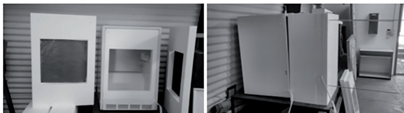
Figura 68. Sistema de medición completo, unidad calefactora y unidad enfriadora, encastre de las placas de EPS.
