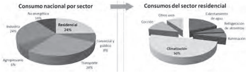
Figura 3. Consumo nacional por sectores y discriminados según usos del sector residencial (Fuente: elaboración propia, con datos de la Secretaría de Energía de la Nación, 2014; Bourges, Gil, 2012).
