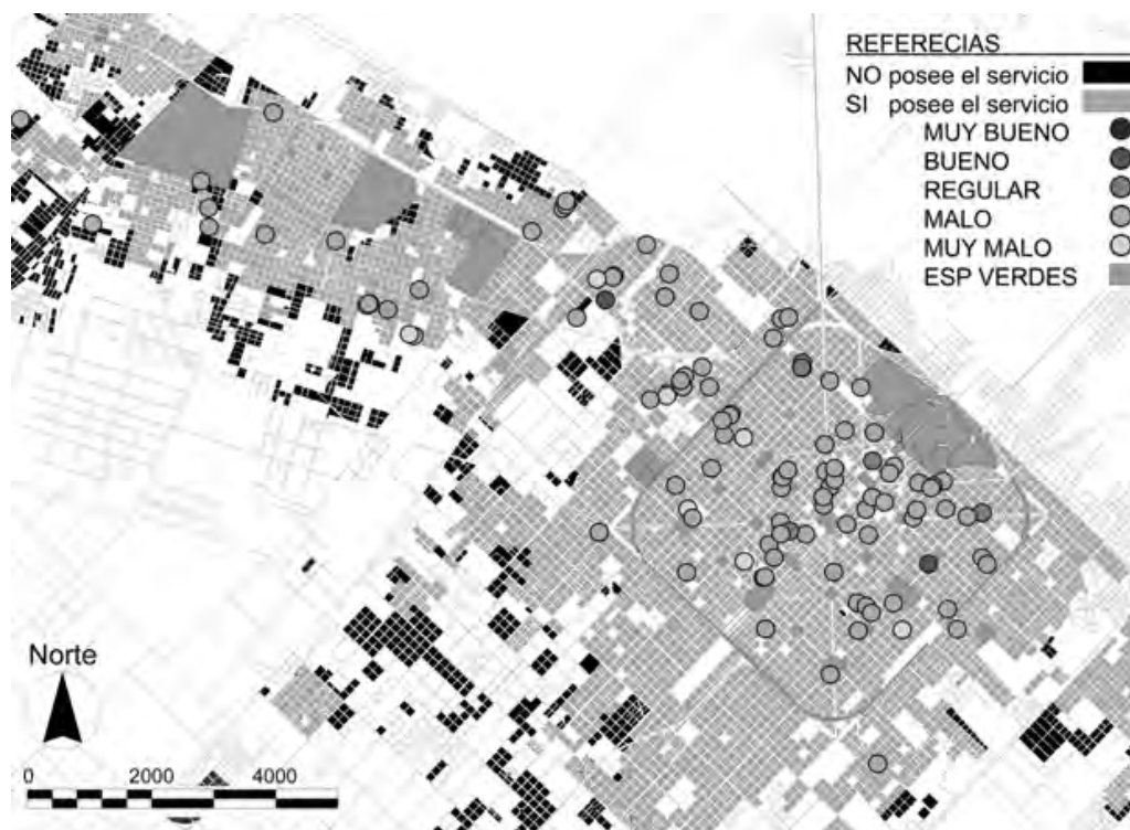
Figura 28. Perfil de cobertura y opinión del Servicio de GN . Fuente: IIPAC. GI 1. Ex UI2-IDEHAB.
