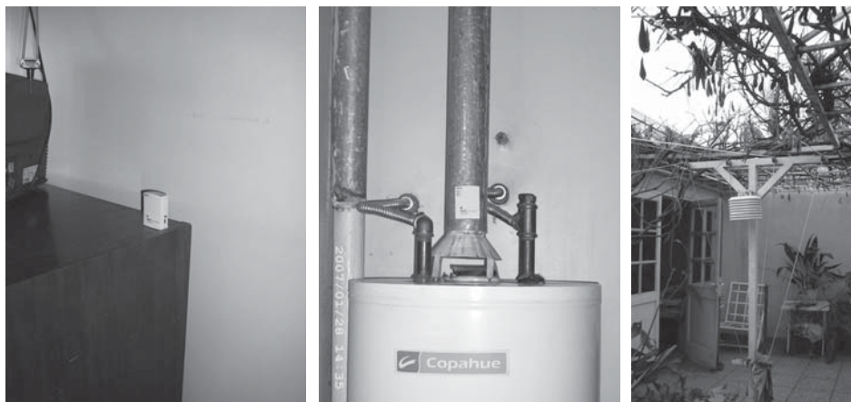
Figura 4-5-6. Ejemplo de ubicación de microadquisidor de datos HOBO en uno de los dormitorios. A la derecha ubicación de la estación meteorológica en el patio de la vivienda.
