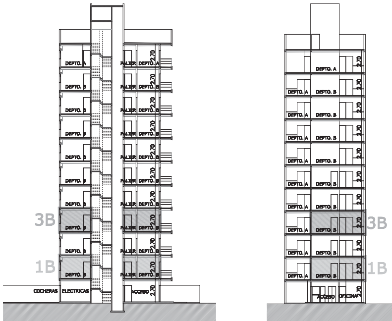
Figura 2. Cortes del edificio analizado.
