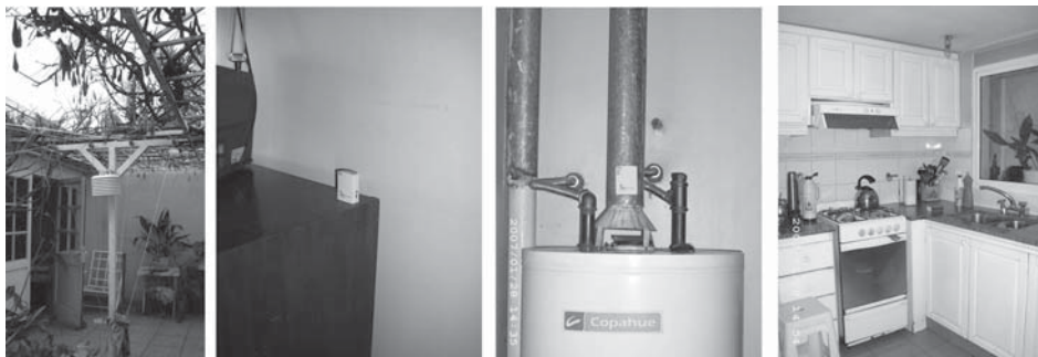
Figuras 3-4-5-6. Estación meteorológica en el patio de la casa. Ejemplo de localización en dormitorio. Ubicación del microadquisidor de datos en conducto del termotanque y cocina.
