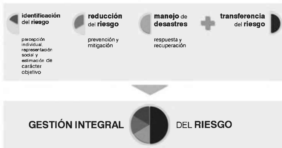
Figura 2. Esquema conceptual. Componentes de la Gestión Integral del Riesgo. Elaboración propia sobre la base de CARDONA (2001)
