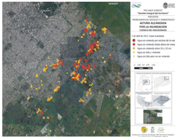
Figura 9. Altura alcanzada por la inundación en la Cuenca del Maldonado
